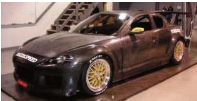
rifaccio: Un telaio tubolare e una carrozzeria simile alla controparte reale. La Mazda RX-8 rappresenta lo spirito del regolamento Silhouette GT
